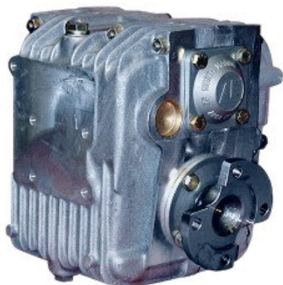
Invertitore inclinato di 8°
